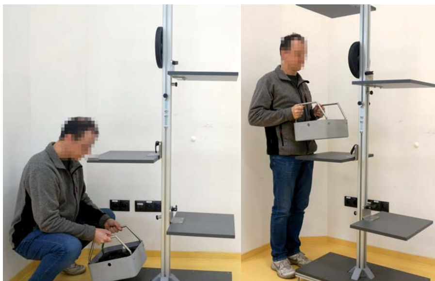
Fot. Ocena zdolności podnoszenia i przenoszenia ładunków (NOF2) Photo. Evaluation of the capability to lift and carry loads (NOF2)
