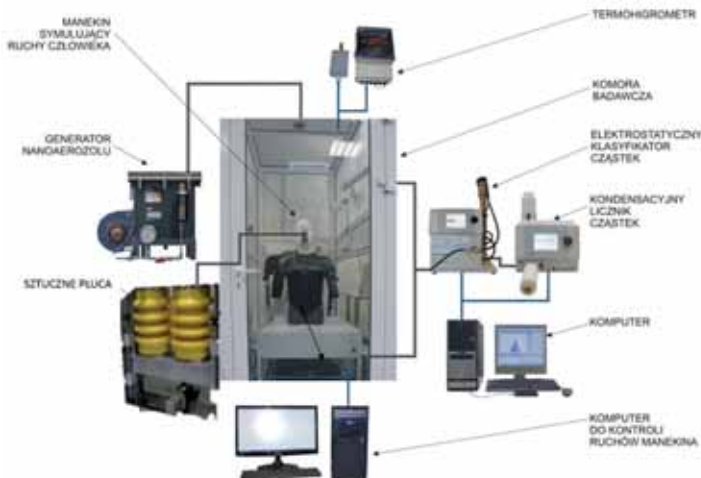
Rys. 9. Schemat stanowiska do badań całkowitego przecieku wewnętrznego wobec nanoaerozolu dla sprzętu filtrującego – rys. CIOP-PIB
