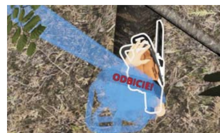
Fot. 5. Wystąpienie odbicia w aplikacji i wizualizacja awatara pilarki łańcuchowej poruszającej się w stronę operatora pilarki (zasoby CIOP-PIB)
