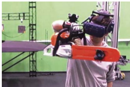
Fot. 3. Interakcja rękawic haptycznych z atrapą pilarki łańcuchowej (zasoby CIOP-PIB) Photo 3. Interaction of haptic gloves with a dummy chainsaw (CIOP-PIB resources)
