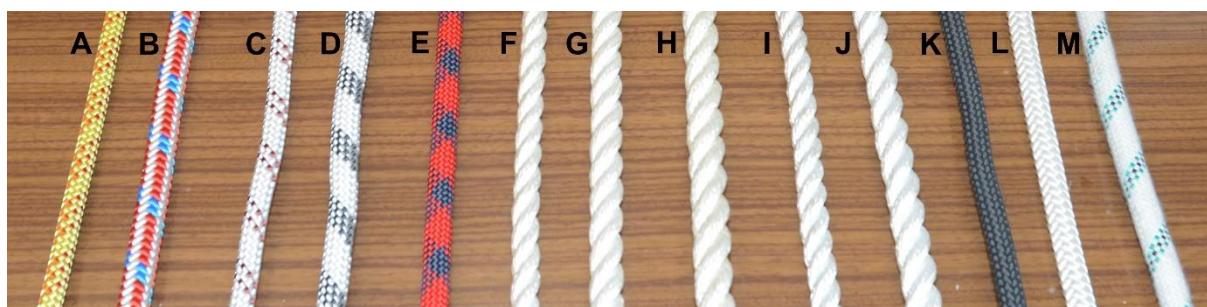
Rys. 1. Liny poddane badaniom zdolności zaciskania węzłów
