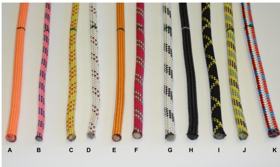
Rys. 3. Liny rdzeniowe poddane badaniom przesuwalności oplotu
