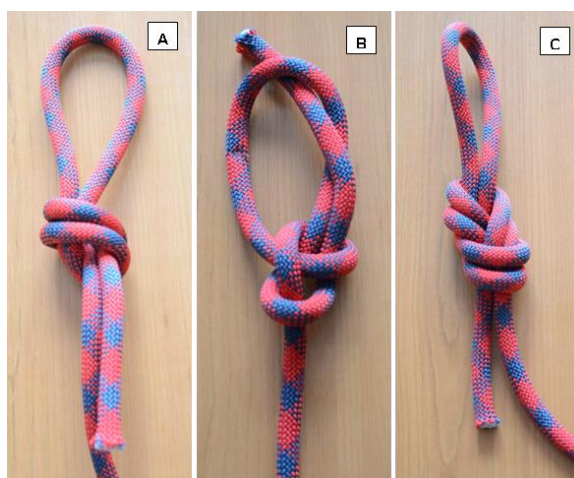
Rys. 5. Węzły na linie włókienniczej poddane badaniom. Oznaczenia: A – węzeł kluczka, B – węzeł skrajny tatrzański, C – węzeł ósemka
