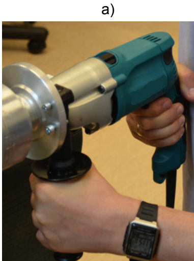
Rys. 8. Praca maszyną ręczną trzymaną za dwa uchwyty, ustawienie: a) poziome, b) pionowe
