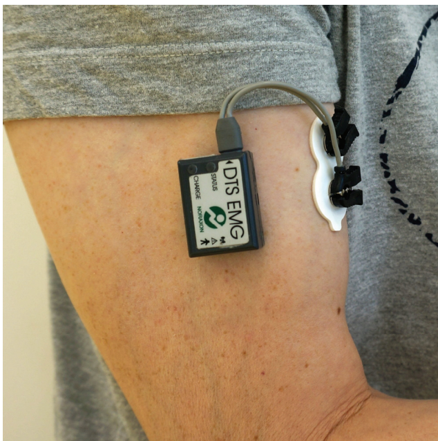
Rys. 6. Sposób przyczepu elektrody EMG dla badanego mięśnia
