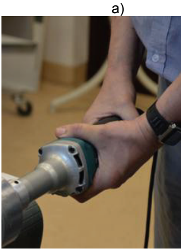
Rys. 7. Typowe ustawienie szlifierki prostej podczas pracy: a) poziome, b) pionowe
