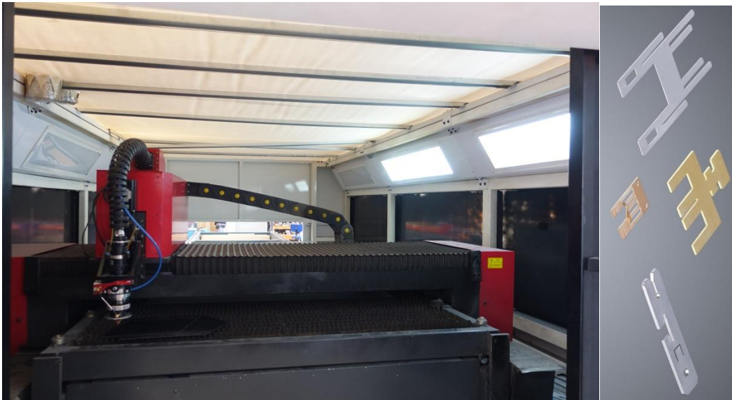
Rys. 22. Automatyczna wycinarka laserowa, która wycina elementy z blachy o dowolnych kształtach, rozmiarach i grubościach
