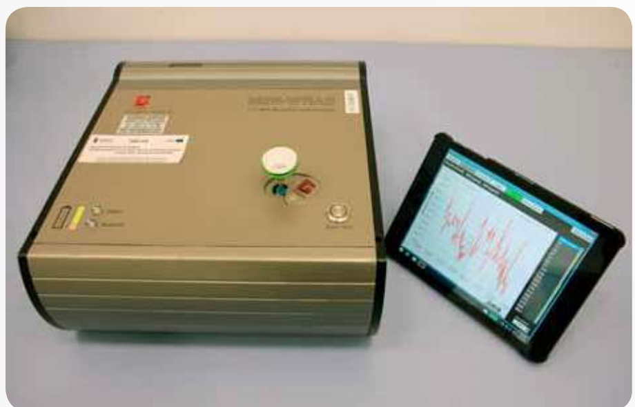
Fot. 2. Spektrometr aerozoli o szerokim zakresie Photo 2. Mini Wide Range Aerosol Spectrometer
