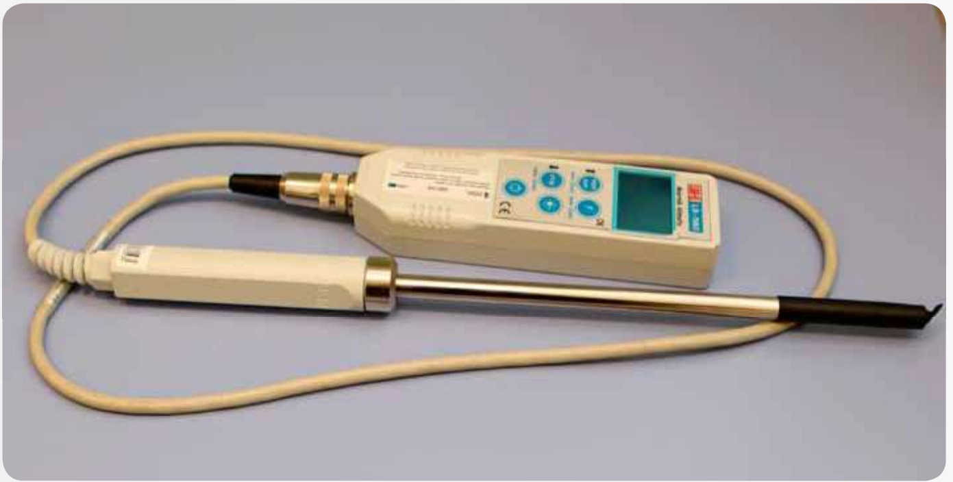
Fot. 3. Termohigrometr do pomiarów parametrów powietrza Photo 3. thermohigrometer for measuring air parameters
