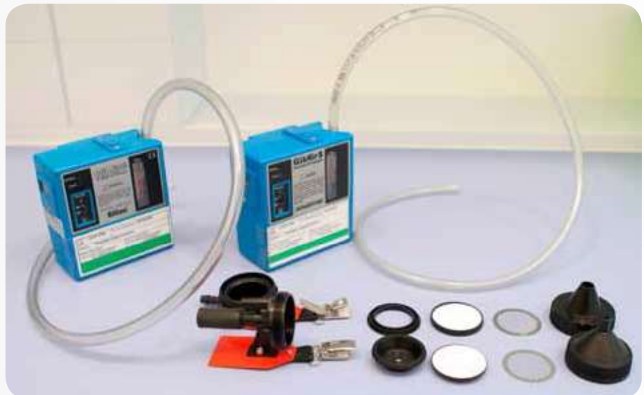
Fot. 1. Zestawy do pomiarów grawimetrycznych frakcji wdychalnej i respirabilnej Photo 1. Sets for gravimetric measurements of inhalable and respirable fractions
