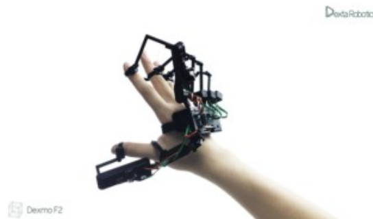
Rysunek 2 Widok rękawic ze sprzężeniem zwrotnym - DexmoF2
