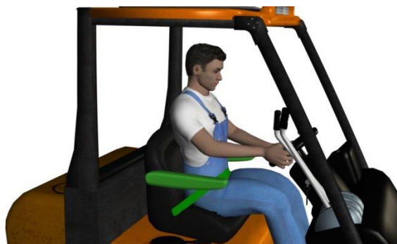
Rys. 9. Konstrukcja wspomagająca utrzymanie operatora w siedzisku – podłokietnik
