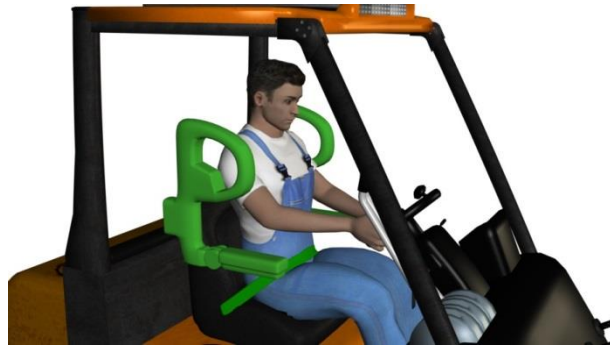
Rys. 10. Rama utrzymująca operatora w siedzisku tzw. seat wings
