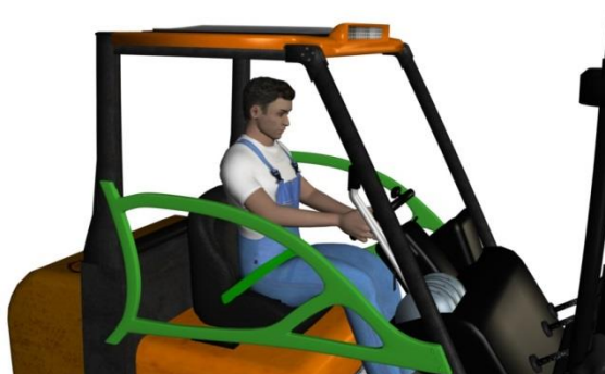
Rys. 8. Konstrukcja chroniąca przed wypadnięciem z wózka w formie dodatkowych drzwi
