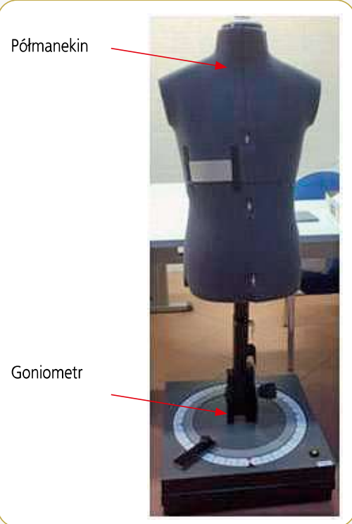
Rys. 2. Goniometr do badania akcesoriów odblaskowych wyposażony w półmanekin
