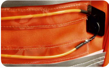
Fot. 1. Widok przewodów świecących typu EL wire Photo 1. EL-Wire luminous wire view
