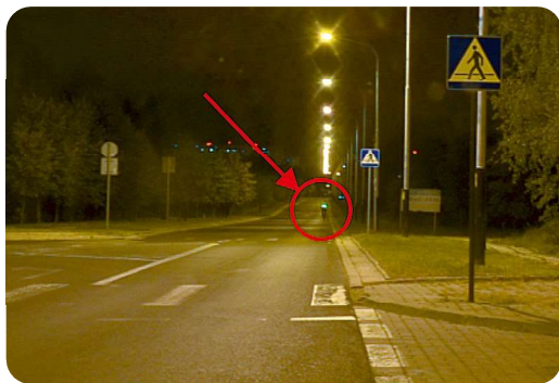
Fot. 10. Widok pola obserwacji modelu odzieży wyposażonego w światłowody SEPOF barwy żółtej w konfiguracji A z odległości 200 m od obserwatorów
