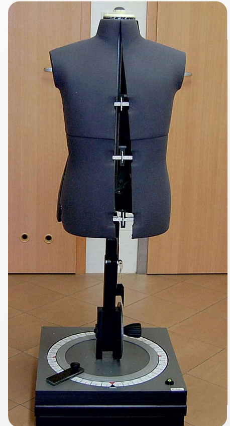
Fot. 5. Widok goniometru z pół-manekinem do regulacji ustawienia Photo 5. A view of a goniometer with a half-mannequin
