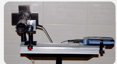
Fot. 6. Widok detektora do pomiaru luminancji i urządzenia do regulacji ustawienia Photo 6. A view of the luminance measurement detector and the placement regulation tool
