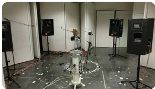
Rys. 1. Stanowisko do badań funkcjonowania układu regulowanego tłumienia ochronników słuchu bezpośrednio po wystąpieniu impulsu akustycznego. Na środku pierwszego planu: pneumatyczne źródło impulsów akustycznych (konstrukcja CIOP-PIB), za tym źródłem: tester akustyczny do badania właściwości akustycznych ochronników słuchu oraz przetwornik do pomiaru właściwości impulsów akustycznych, po obu stronach na pierwszym planie oraz w głębi – łącznie cztery zestawy głośnikowe do odtwarzania szumu
