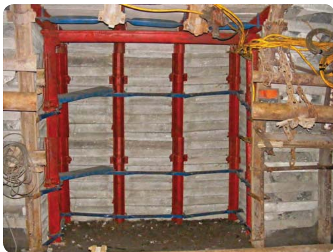
Fot. 1. Widok zaprojektowanego i wykonanego miejsca pracy obsługi przenośnika taśmowego w przekopie 106 b (wnęka technologiczna przed adaptacją akustyczną)
