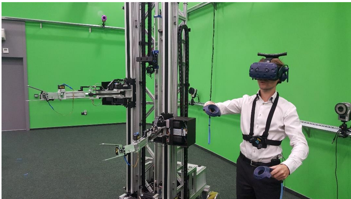
Rys. 1. Sterowanie dwuramiennym robotem mobilnym przez operatora z wykorzystaniem HMD i bezprzewodowych kontrolerów HTC Vive Pro (pełniących w tym przypadku funkcję elementów sterowniczych). Ruchy kończyn górnych operatora są odtwarzane przez silniki ramion robota. Obraz z kamer robota jest przesyłany drogą bezprzewodową do HMD (nad głową operatora widoczna jest antena odbierająca sygnał wideo)
