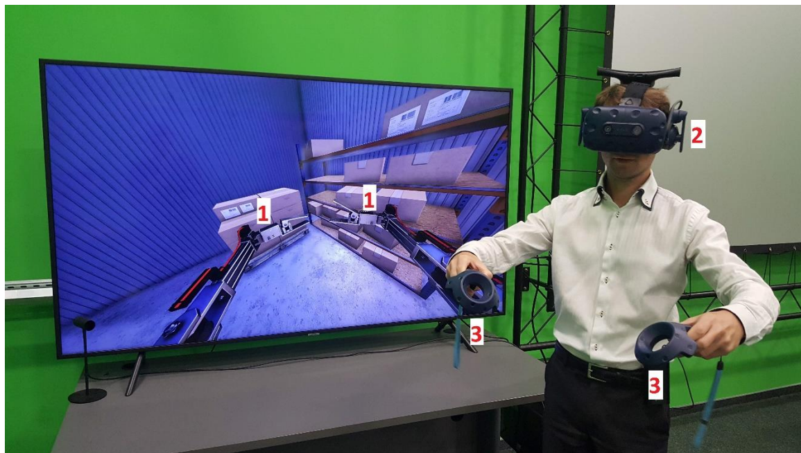
Rys. 2. Sterowanie wirtualnym modelem dwuramiennego robota mobilnego z wykorzystaniem systemu pomiarowego typu motion capture . Na ekranie wyświetlany jest obraz obserwowany przez operatora poprzez gogle rzeczywistości wirtualnej. 1 – ramiona wirtualnego modelu robota, 2 – gogle rzeczywistości wirtualnej, 3 – trzymane w dłoniach kontrolery, których położenie i orientacja wyznaczone są za pomocą systemu typu motion capture . Ruch chwytaków zainstalowanych na końcach ramion (1) odwzorowuje ruch trzymany w dłoniach kontrolerów (3), natomiast ruch głowy powoduje taki sam ruch wirtualnych kamer i zmianę obrazu wyświetlanego w goglach rzeczywistości wirtualnej (2)
