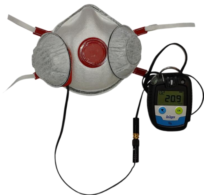
Rysunek 1. Półmaska filtrująca wyposażona we wskaźnik tlenu
