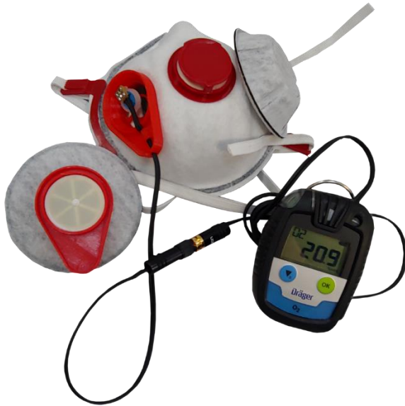
Rysunek 2. Sposób zamontowania sensora tlenu w konstrukcji półmaski filtrującej
