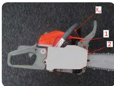
Rys. 7. Sposób sprawdzenia możliwości przecięcia zewnętrznego konturu osłony przedniej i/lub korpusu pilarki przez linię łączącą punkt X_0 i umieszczony najbardziej z tyłu nieosłonięty element piły łańcuchowej: 1 – punkt przecięcia, 2 – nieosłonięty element piły łańcuchowej, X_0 – punkt odniesienia Fig. 7. Determination method of the possibility of crossing the outline of the forward cover and/or the chainsaw's body and the line connecting X_0 and the chainsaw's uncovered element placed the most to its back: 1 – crossing point, 2 – uncovered chainsaw's element, X_0 – reference point
