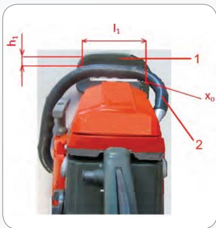
Rys. 4. Wyznaczanie efektywnej długości osłony przedniej: h_1 – wysokość osłony przedniej ponad uchwytem przednim przy odłączonym hamulcu ręcznym, X_0 – punkt odniesienia, 1 – osłona przednia, 2 – uchwyt przedni
