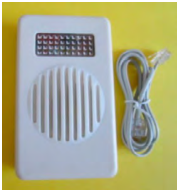
Rys. 44-1. Urządzenie do sygnalizacji świetlnej informującej o przychodzącym połączeniu telefonicznym
