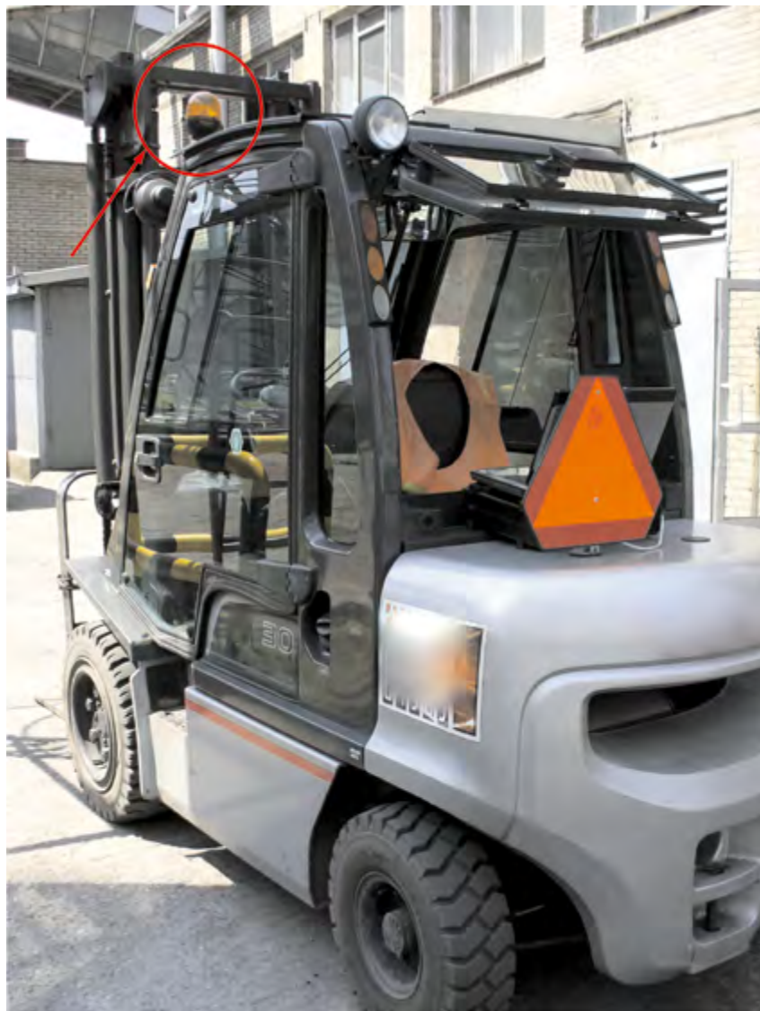
Rys. 46-1. Wózek jezdniowy wyposażony w sygnalizację dźwiękową i świetlną
