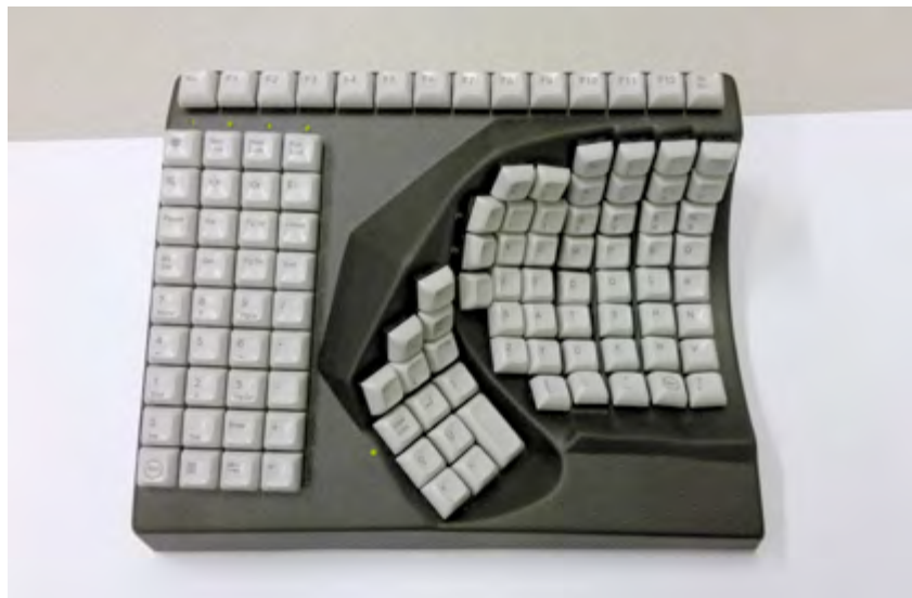
Rys. 61-1. Klawiatura dla osób z niepełnosprawnością lewej kończyny górnej lub po jej amputacji
