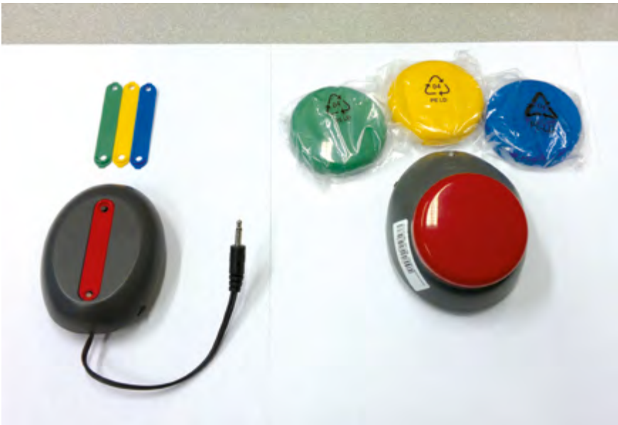
Rys. 63-1. Zdalne przyciski: a) nadajnik, b) odbiornik i nadajnik (różne kolory przycisku)
