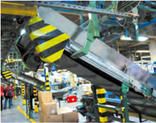
Rys. 76-1. Oznakowane (żółto-czarnymi ukośnymi pasami) elementy obniżające wysokość przejścia (a, b, c, d); miejsca stwarzające zagrożenie urazem głowy oznakowane dodatkowo znakami ostrzegawczymi: niebezpieczeństwo uszkodzenia głowy (a) i ograniczenie wysokości przejścia do wysokości 1,8 m (b)
