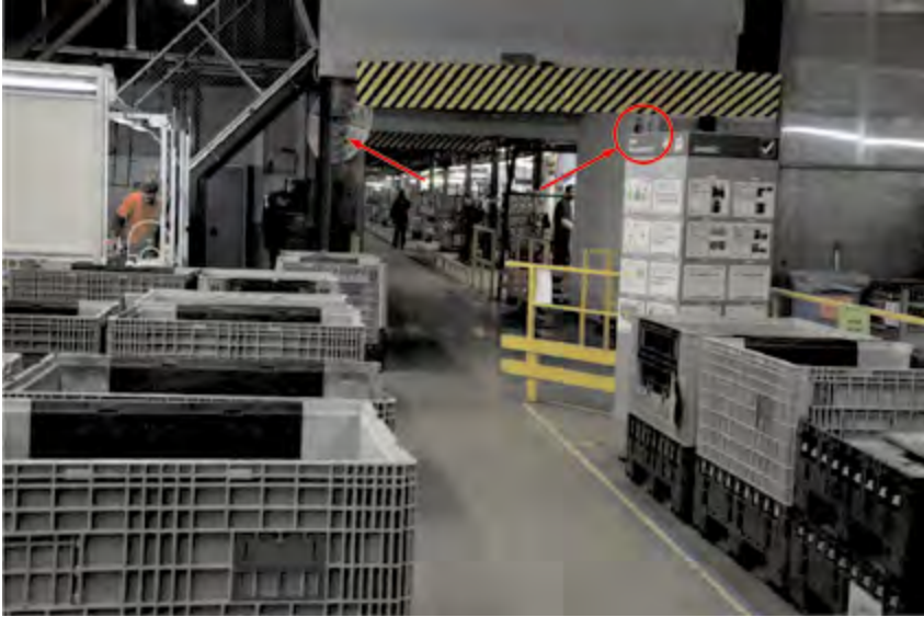
Rys. 47-1. Oznakowanie dźwiękowe i świetlne przejścia dla pieszych w hali produkcyjnej (sygnalizator dźwiękowy i świetlny informujący o zbliżającym się wózku jezdniowym oraz lustro wspomagające widoczność)
