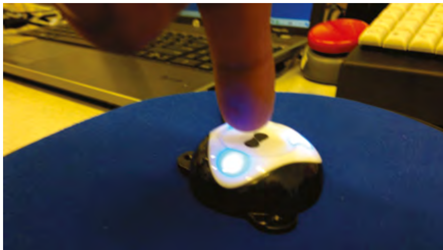
Rys. 57-1. Przycisk o zwiększonej czułości spełniający funkcję przycisku myszy komputerowej
