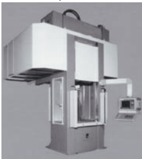
Rys. 1. Prasa hydrauliczna wyposażona w kurtyne świetlną oraz osłony boczne i tylne
