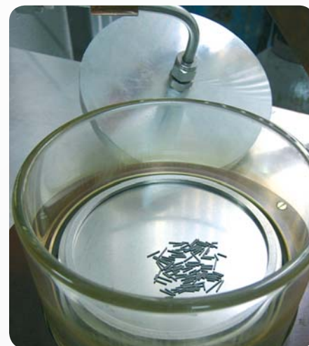
Fot. Sposób umieszczenia obrabianego sorbentu węglowego w komorze reaktora plazmowego Photo. Placement method of the carbon sorbent treated in the plasma reactor
