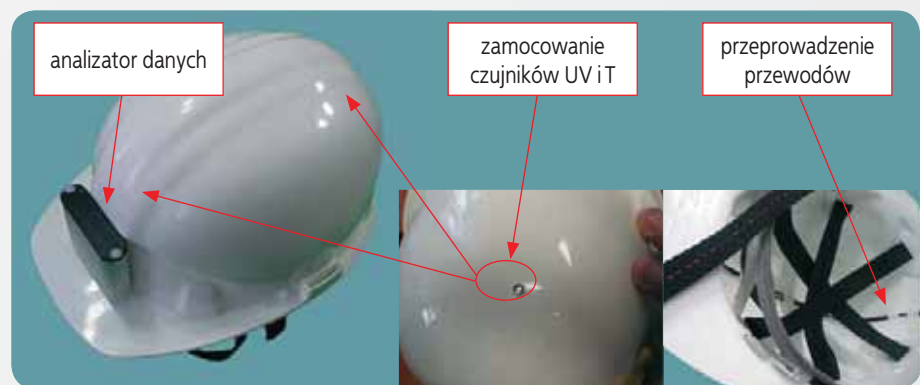
Fot. 2. Elementy modelu elektronicznego systemu monitorowania promieniowania nadfioletowego i temperatury wbudowane w przemysłowym hełmie ochronnym
