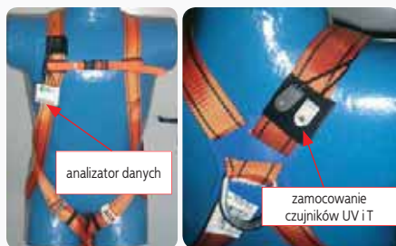
Fot. 3. Elementy modelu elektronicznego systemu monitorowania promieniowania nadfioletowego i temperatury zamocowane na szelkach bezpieczeństwa
